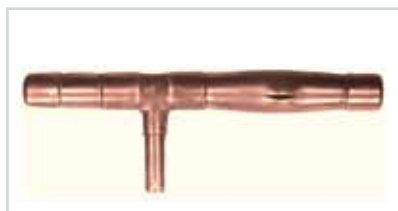
Bild 5.2 Weichgelötete Rohrkomination 22 x 1 mm nach einer Berstdruckprobe von 280 bar (1063)
