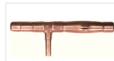
Bild 5.2 Weichgelötete Rohrkombination 22 x 1 mm nach einer Berstdruckprobe von 280 bar (1063)
