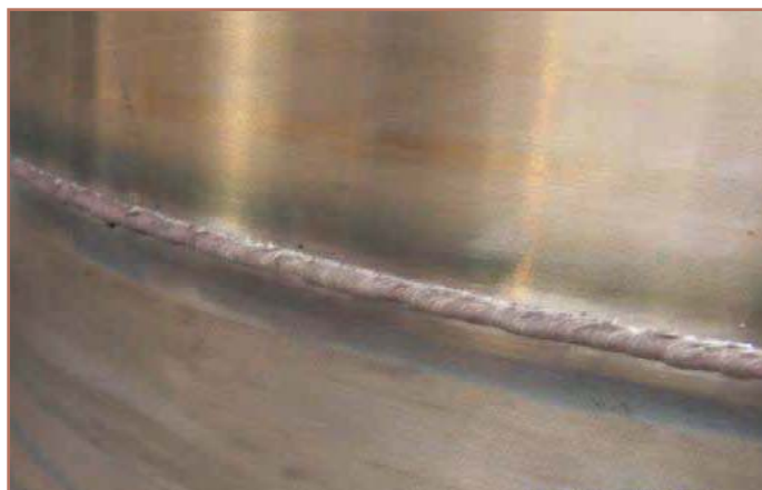
Abbildung 13: Elektronenstrahlgeschweißte Bronzebuchse aus CuSn12Pb mit 68 mm Einschweißtiefe [56]
