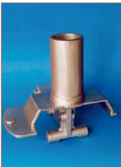
Abbildung 19: Schwenklager aus 6 mm dickem CuAl11Fe6Ni6-C-GM, unter Ar WIG-geschweißt mit Zusatzwerkstoff CuAl8 [83]
