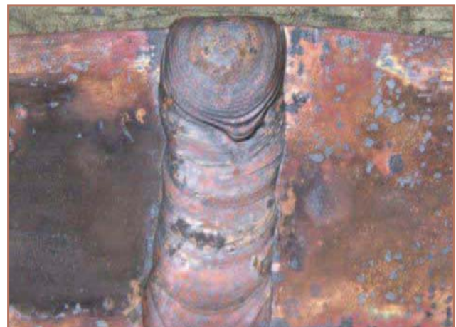
Abbildung 17: WIG-geschweißter Stromring aus 6 mm Cu-ETP mit Zusatzwerkstoff CuAg1 unter Ar, V-Naht mit Kohlebadabsicherung [82]
