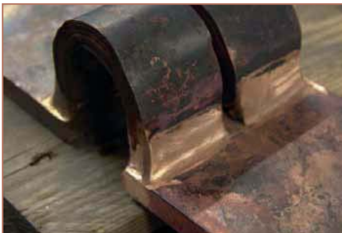
Abbildung 16: WIG-geschweißte Doppellamellenverbindung aus Cu-ETP mit Zusatzwerkstoff CuSn1 unter Ar, Grundplatte 15 mm, Lamellen je 0,5 mm [81]
