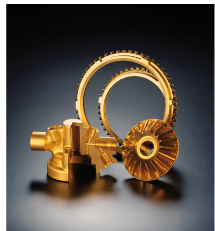
Bild 22: Schmiedeteile aus CuZn40Pb2
