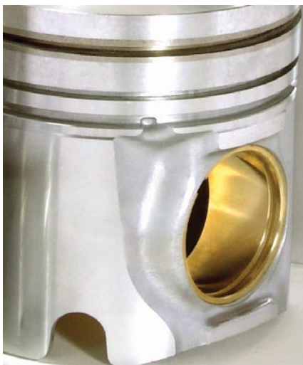
Bild 26: Kolbenaugenbuchsen gefertigt aus Rohren, CuZn31Si7
