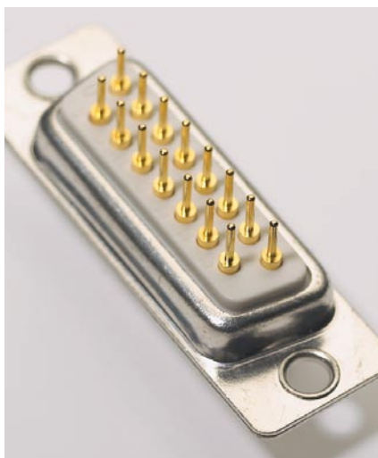
Bild 28: PC-Stecker: Gehäuse gefertigt aus Band CuZn37 verzinkt, Stifte gefertigt aus Draht, CuZn38Pb2
