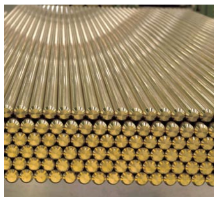
Bild 20: Stangen für Kugelschreiberspitzen gefertigt aus Draht CuZn39Pb3
