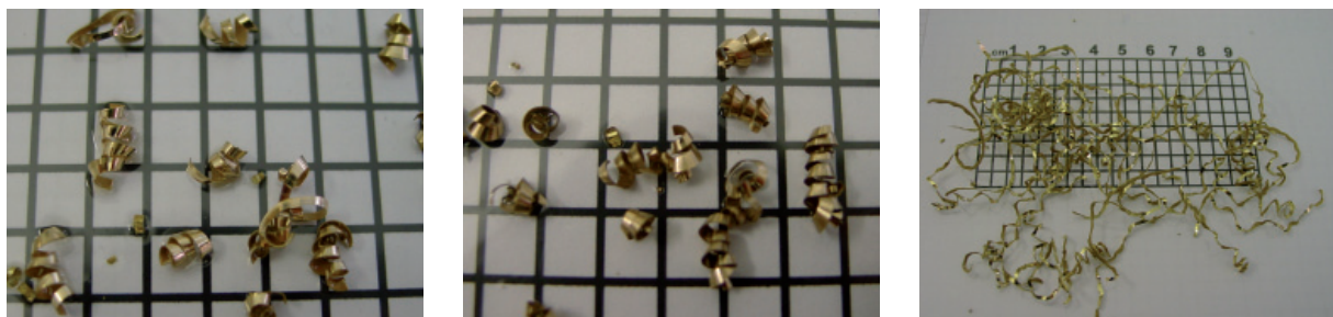
Bild 3: Späne nach Außendrehen unter gleichen Bedingungen von links BlueBrass®42, Mitte CuZn39Pb3; rechts CuZn36
