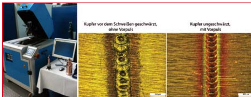
Bild 8: Nexans UniCross Quernahtschweißanlage für die Herstellung von Rohren und Kabeln; mit Nexans UniCross erzeugte Quernahte auf Kupfer (Wieland K12), Dicke 0,2 mm
