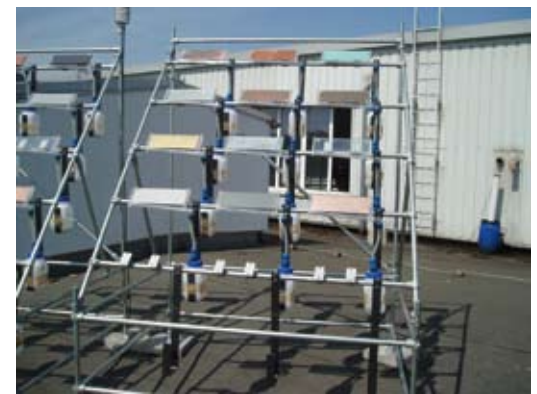
Bild 6: Versuchsstand nach ISO/DIS 17752
