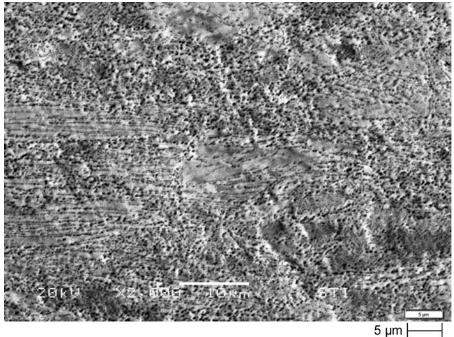
Bild 5: Verformtes Gefüge, CuMg 2,5 ; \phi_h = 2,1 ; 400 °C, 8 h; 2.000-fach, REM (BSE)
