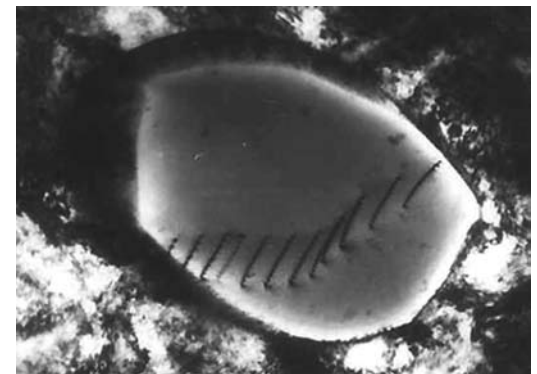
Bild 1: Schematische Darstellung und transmissionselektronenmikroskopische Aufnahme von Versetzungen in einem kristallinen Gitter (Quelle: Wikipedia, oben: A.N. Cutler, unten: Wikityke)
