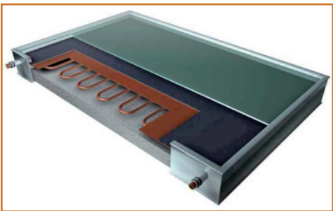
Bild 5: Prinzipskizze eines Solar-Flachkollektors (Mäandertyp)
