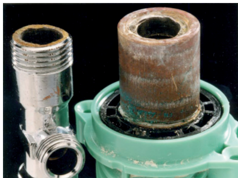
Bild 1: Beispiel für ein gebrochenes Eckventil
