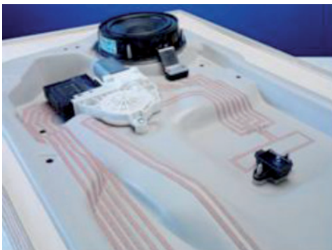
Bild 1: Beispiel zur alternativen Verdrahtung an einem Türmodul. Die Rundleiterverdrahtung wurde durch aufgesprühte Kupferbahnen ersetzt.
