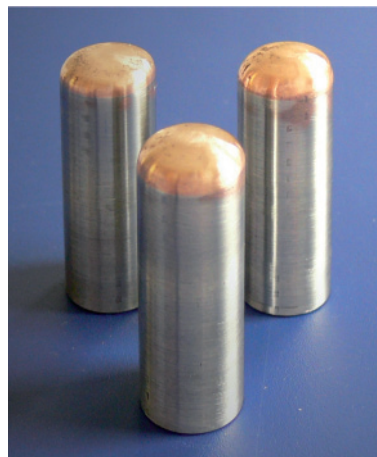
Bild 3: Gegenüberstellung der thermisch gespritzten (links) und pulvermetallurgisch hergestellten (rechts) Schleifstifte
