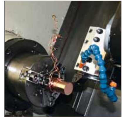
Bild 4: Spanbildung schwer zerspanbarer Werkstoff CuCr1Zr
