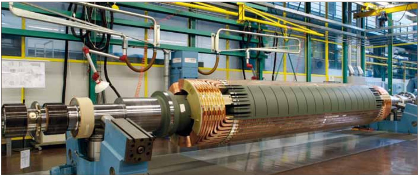
Bild 6: Rotor für Turbogenerator mit CuAg-Läuferstäben
