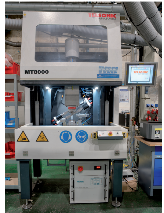
Bild 3: Torsionale Ultraschallschweißanlage Telsonic MT8000 PowerWheel
