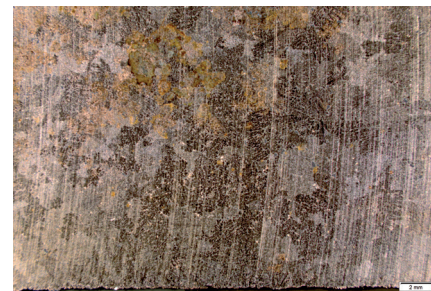
Bild 21: grobkörniges Gefüge nach langsamer Abkühlung (Makroätzung)
