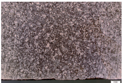
Bild 20: feinkörniges Gefüge bei schneller Abkühlung (Makroätzung)
