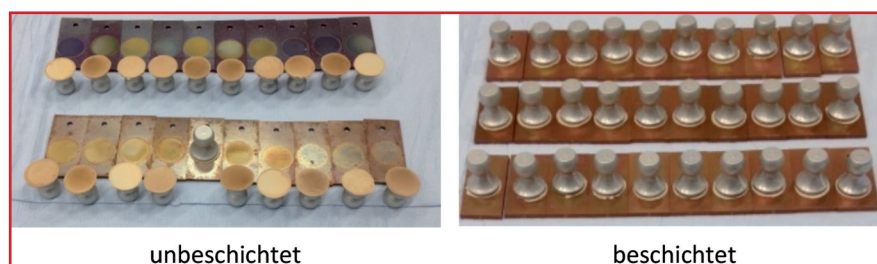
Bild 6: Klebeverbindung nach dem Klimawechseltest - links unbeschichtete Kupfersubstrate - rechts beschichtete Kupfersubstrate
