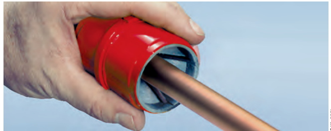
Entgraten (hier Außenentgraten)
