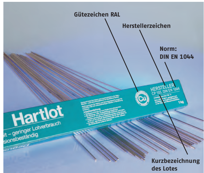
Hartlotstangen mit vollständiger Kennzeichnung
