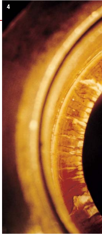
Bild 4 • Dauerbruch-Rastlinien von außen nach innen aufgrund Kerbwirkung durch den "scharfen" Messing-Klemmring
