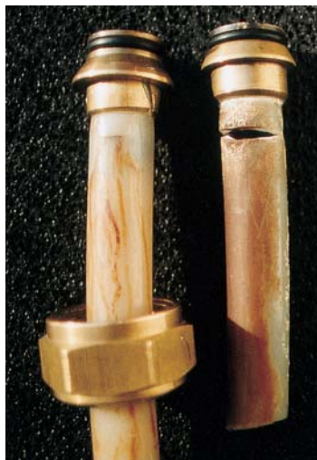
Bild 1 • Klemmverbinder aus Messing für den Anschluss von PE-X-Rohren an Heizkreisverteiler mit gerissenen PE-X-Rohren
