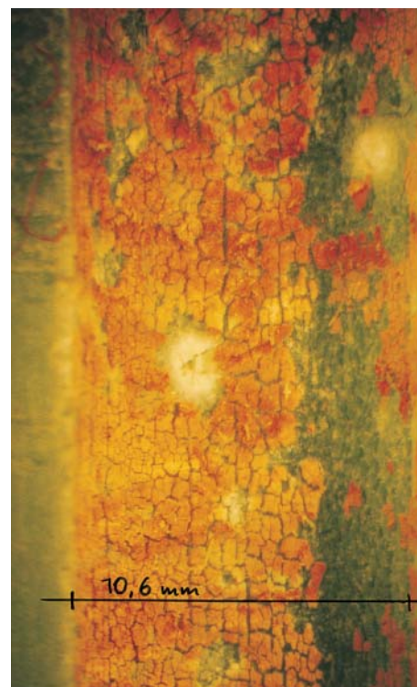
Bild 2+3 • PP-Typ 3, WW-Zirkulationsleitung 16 x 2,7 mm; PN 20. Zerstörung der makromolekularen Struktur durch Alterung. Aufreißen der Innenoberfläche durch Quer- und in Extrusionsrichtung des Rohres ausgerichtete Längsrisse.
