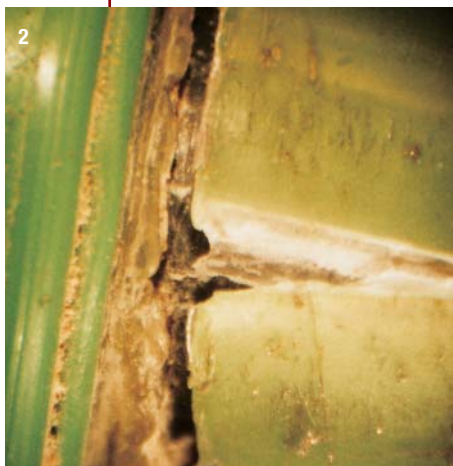
Bild 1 • Mehrschichtenrohr ohne Verbundhaftung
