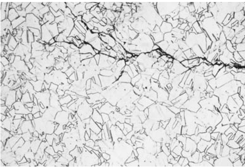
Bild 3-5 • Verzweigter Nebenriss (ausgehend von der Rohrinne) mit transkristallinem und interkristallinem Verlauf
