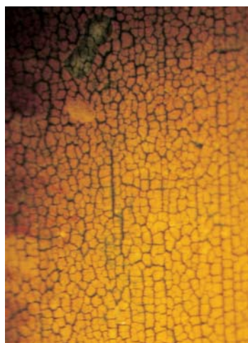
Bild 2+3 • PP-Typ 3, WW-Zirkulationsleitung 16 x 2,7 mm; PN 20. Zerstörung der makromolekularen Struktur durch Alterung. Aufreißen der Innenoberfläche durch Quer- und in Extrusionsrichtung des Rohres ausgerichtete Längsrisse.
