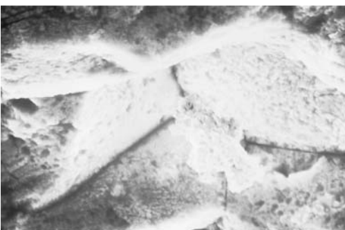
Bild 7 • Detail der Bruchfläche: Die Partikel auf der Bruchfläche bestehen aus Aluminium
