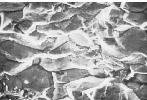
Bild 6 • Interkristalliner Bruch mit Spuren von Schwefel auf der Bruchoberfläche
