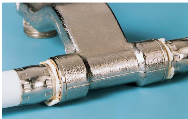
Bild 5 oben • Antritt des Schichtenklebers (Haftvermittler) zwischen Aluminiumschicht und Exliner.
