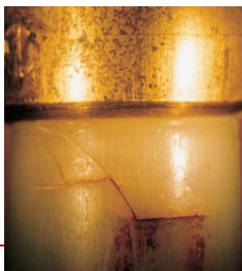
Bild 2 • Rissbildungen (klaffender Querriss und Anrisse bis 15 mm Länge) an PE-X 14 x 2 mm in der Nähe des Klemmringverbinders. Rissentfernung vom Klemmring ca. 7, 15 und 25 mm! Alle Risse einseitig auf der nach innen gebogenen Seite.
