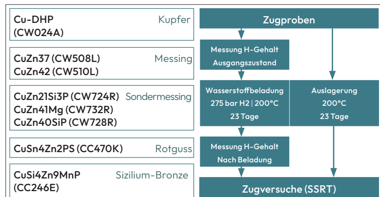
Abb. 1: Ausgewählte bleifreie Installationswerkstoffe und Testparameter.
