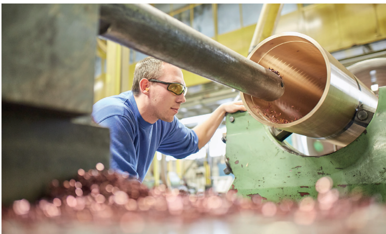
Moderne bleifreie Kupferlegierungen sind sehr gut bearbeitbar. 1
